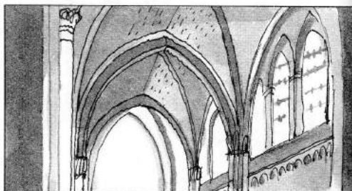
Le poids de la voûte gothique , en arc brisé, est transféré sur les piliers. Les murs sont moins épais. On peut ainsi percer de larges ouvertures qui laissent entrer la lumière.
